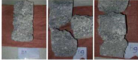
Figure 5 : Aspect des éprouvettes 11x22 après essai de compression à la rupture.
